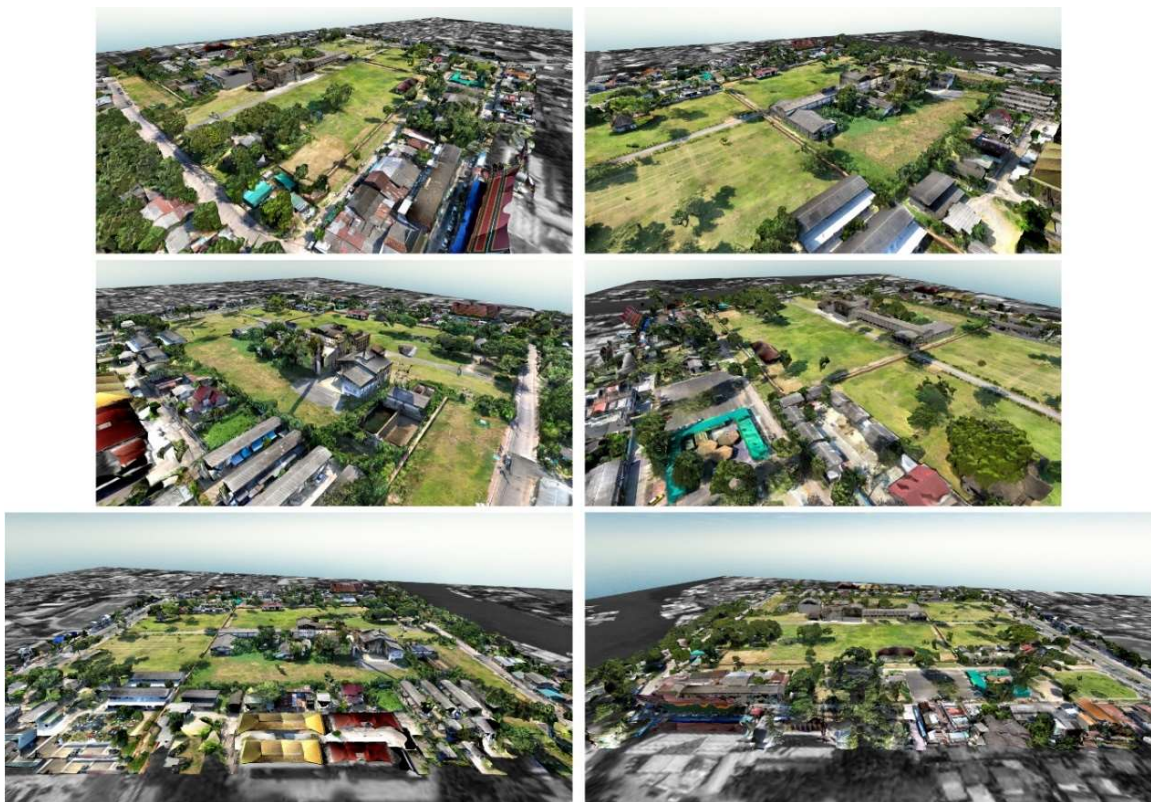
ภาพที่ 28 ภาพ 3D Map จากการใช้อากาศยานไร้คนขับและประมวลผล Point cloud ด้วยโปรแกรม Global Mapper 21+LiDAR Module 21
