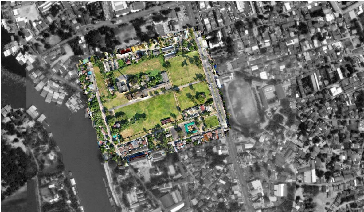
ภาพที่ 27 ภาพ Ortho จากการใช้อากาศยานไร้คนขับและประมวลผล Point cloud ด้วยโปรแกรม Global Mapper 21+LiDAR Module 21
